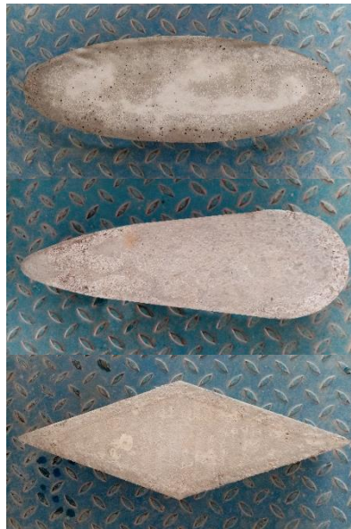
شکل ۲- هندسه پشته‌های مورد استفاده شامل بیضی (بالا)، گوه‌ای (وسط) و لوزی (پایین).
