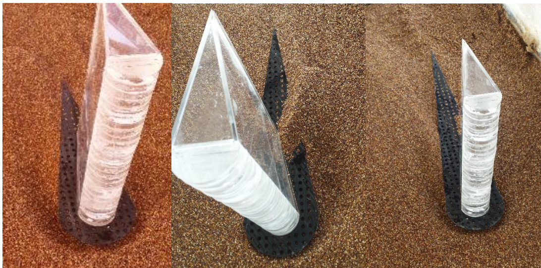
شکل ۹- تصاویری از آب‌شستگی.
