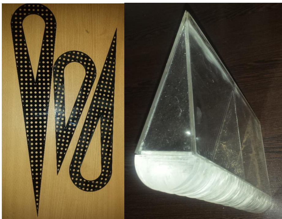
شکل ۴- طوقه و پایه پل آنرویدینامیک ساخته شده.
