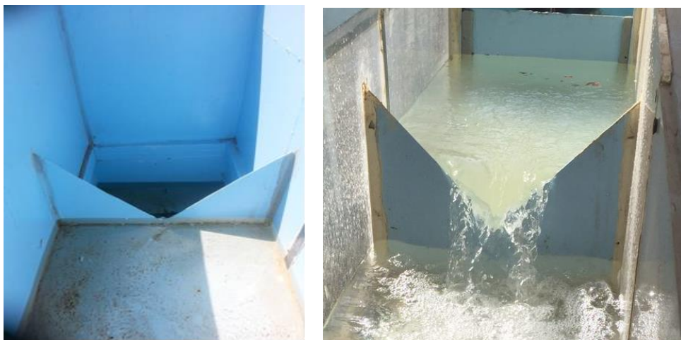
شکل ۲- سرریزهای ورودی و خروجی مثلثی با رأس ۹۰ درجه، در ابتدا و انتهای فلوم.
