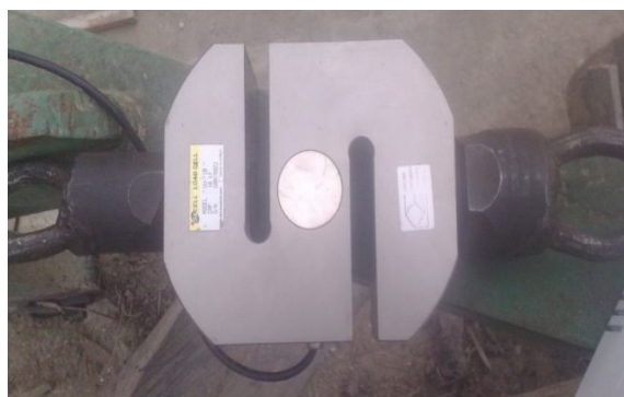
شکل ۲- نیروسنج S شکل نصب شده بین دو تراکتور در کشش دو تراکتوری. Figure 2. S shaped loadcell installed between tractors at RNAM test.
