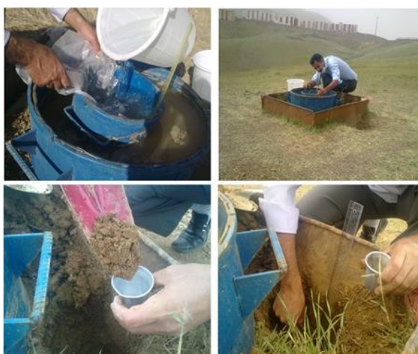
شکل ۲- اندازه‌گیری نفوذپذیری با استفاده از استوانه مضاعف و نمونه‌برداری خاک برای اندازه‌گیری رطوبت خاک.
