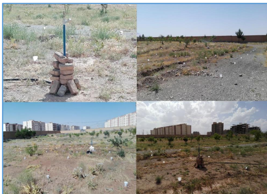
شکل ۱- نمای قرارگیری آبیاش منفرد و شبکه ظروف جمع‌آوری آب.
