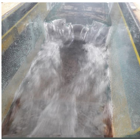
شکل ۵- نمایی از قرارگیری سرریز دریچه- مرکب قوسی در کانال.
