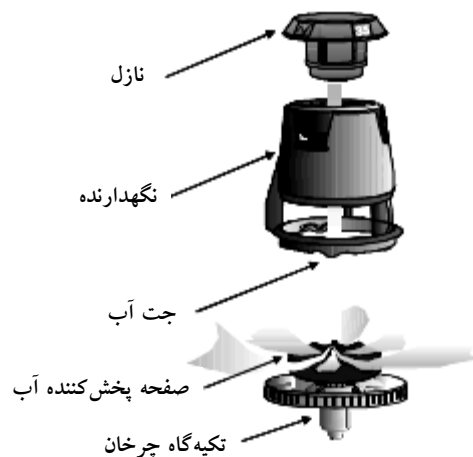
شکل ۲- اجزا نازل دوار شرکت نلسون.
