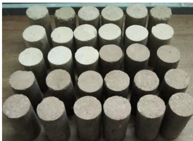
شکل ۴- تیمارهای خشک شده پس از خروج از قالب.
