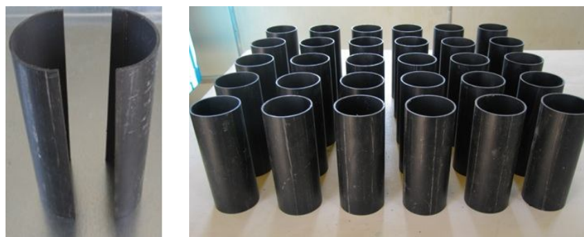
شکل ۲- قالب‌های استوانه‌ای از جنس پلیکا.
