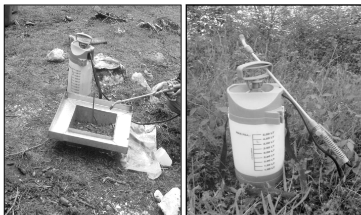
شکل ۲- باران‌ساز فشاری (راست) و نمایی از کرت‌های کوچک آزمایشی مورد استفاده (چپ).
