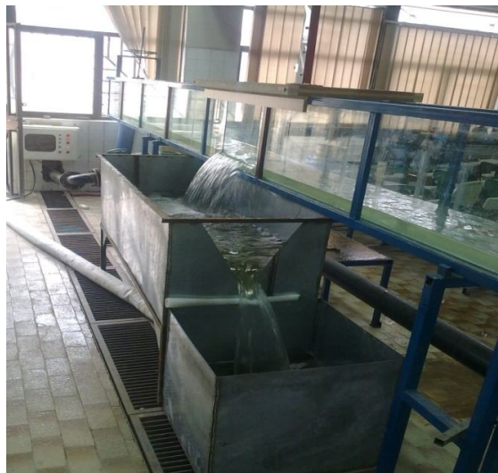
شکل ۳- فلوم آزمایشگاهی، سرریز جانبی، سرریز مثلثی و عمق سنج.
