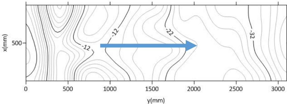
شکل ۲۱- الگوی آب شستگی در شرایط عبور جریان آب از سرریز و کل لوله ها.
