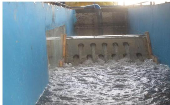
شکل ۴- خروج آب از کلیه لوله‌ها و سرربز.
