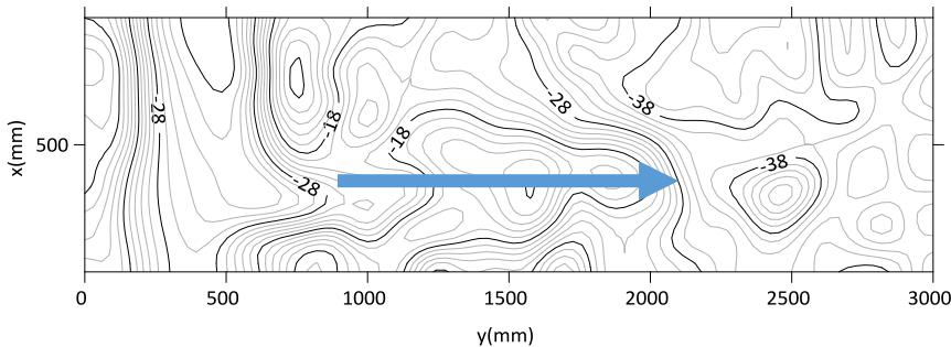
شکل ۲۰- الگوی آب شستگی در صورتی که جریان آب از روی سرریز به تنهایی عبور نماید (روش صفحه ترکیبی).
