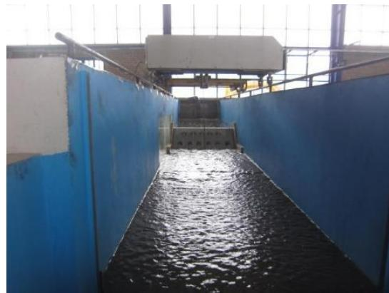
شکل ۳- کanal و دستگاه اندازه‌گیری پروفیل بستر.
