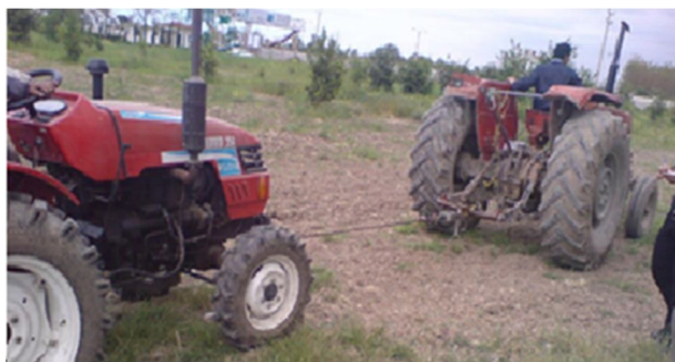
شکل ۳- انجام کشش دو تراکتوری (RNAM) در مزرعه.
