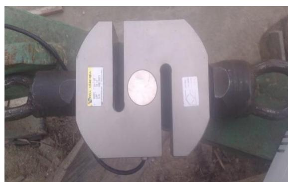
شکل ۲- نیروسنجد S شکل نصب شده بین دو تراکتوری.
