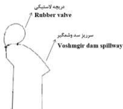
شکل ۶- سرریز سد و شمگیر و دریچه لاستیکی (سمت راست شماتیک و سمت چپ مدل آزمایشگاهی).
