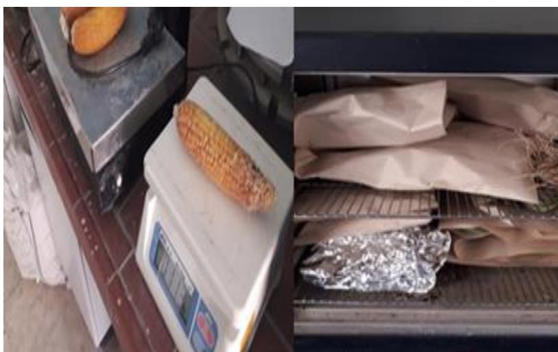
شکل ۲- وضعیت خشک شدن اجزای گیاه ذرت شیرین در آون و اندازه‌گیری‌های اجزای آن.
