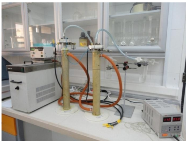
شکل ۳- دستگاه غنی‌سازی تریتیوم استفاده شده جهت تغلیظ نمونه‌ها.
