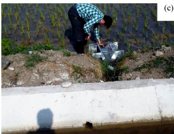
شکل ۵- فلوم RBC ۱۰۰ میلی‌متری: الف) طرح شماتیک و ابعاد فلوم، ب) کالیبراسیون فلوم و پ) اندازه‌گیری دبی در کانال بتنی. Figure 5. RBC Flume (100mm): a) Scheme and Dimension, b) Flume Calibration and c) Water measurement in lined Channel.
