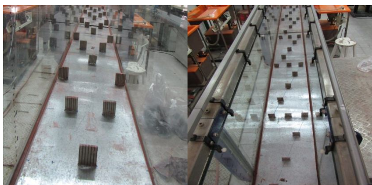
شکل ۴- آرایش صفحه‌ها به صورت همگرا و Z شکل.
