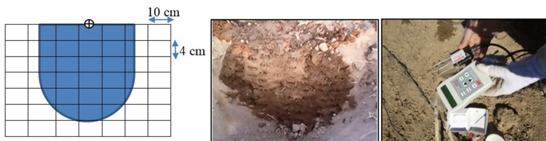
شکل ۱- سنسور WET برای اندازه‌گیری رطوبت و پروفیل رطوبتی خاک مربوط به آبیاری قطره‌ای.
