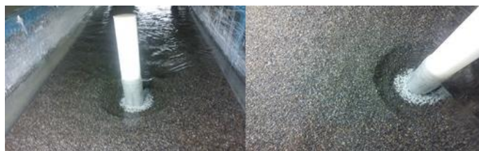
شکل ۱۰- نمایی از وضعیت حفره آب‌شستگی که با مواد نانورس محافظت شده است.
