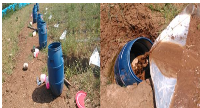
شکل ۳- نمونه‌برداری رواناب از آب جمع‌آوری شده در انتهای کرت‌ها.
