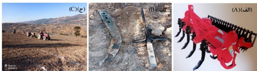
شکل ۱- (الف) دستگاه خاک‌ورز، (ب) ضمیمه ریشه‌بر و (ج) روش کشش دو تراکتوری به همراه کرت‌بندی مورد استفاده در آزمون‌های مزرعه‌ای.
