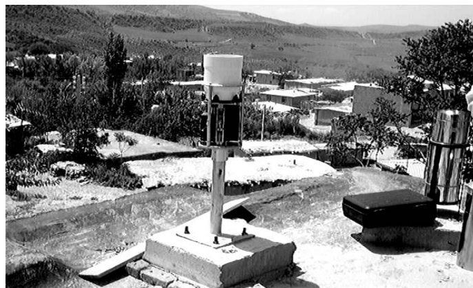
شکل ۲- باران‌سنج ثابت ایستگاه آقامام.
