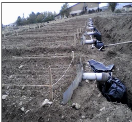
شکل ۳- نمایی از مخازن جمع‌آوری رواناب و رسوب مستقر در خروجی کرت‌ها.
