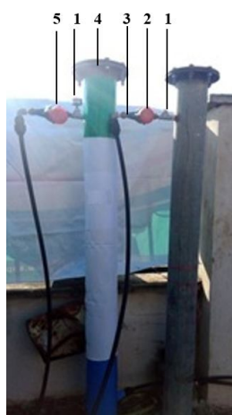
شکل ۱- نمایی از مدل فیلتر شنی تحت فشار با محتویات سیلیس.
