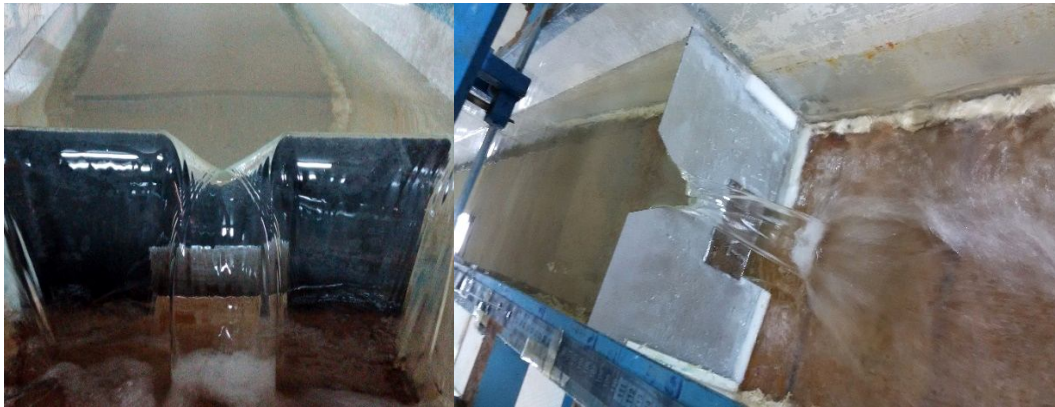
شکل ۳- مدل فیزیکی سیستم ترکیبی سرریز مرکب (مثلثی-مستطیلی)- روزنه با دهانه مثلثی ۶۰ و ۹۰ درجه.
