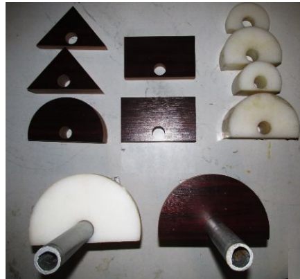
شکل ۴- چند نمونه از مدل اجسام شناور با هندسه‌های مختلف به کار رفته در پژوهش.
