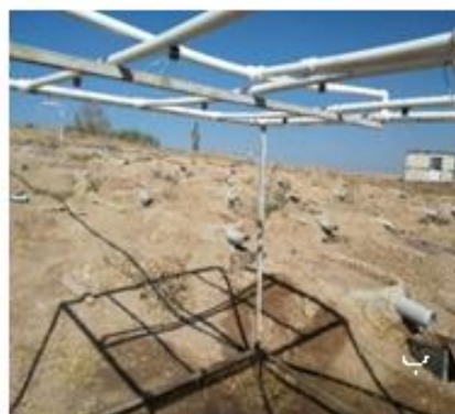
شکل ۳- نمایی از باران‌ساز مورد استفاده در آزمایش (الف) و صفحه بارش آن (ب).
