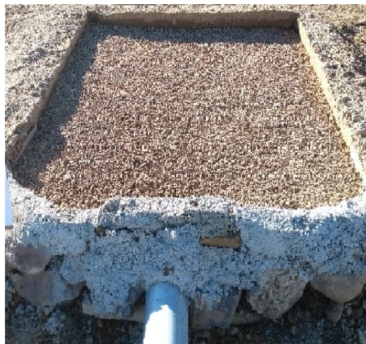
شکل ۲- نمایی از کرت فرسایشی حاوی خاکدانه‌های خاک.
