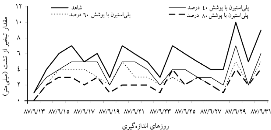
شکل ۴- تغییرات مقدار تبخیر از تشت شاهد و تیمارهای پوشانده شده با پلی استیرن (مرحله دوم).
