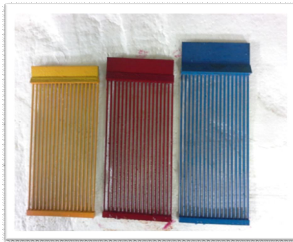
شکل ۵- آبشکن‌های مورد استفاده در این پژوهش.
