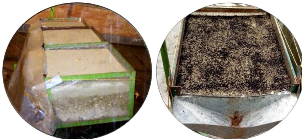
شکل ۲- کرت‌های آزمایشی در حین (چپ) و بعد از شبیه‌سازی باران (راست).
