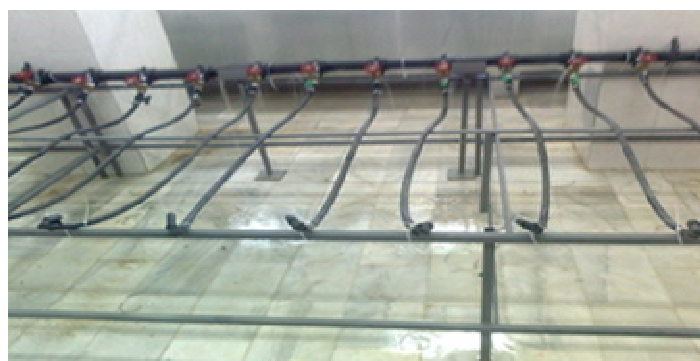
شکل ۱- نمای کلی از مدل فیزیکی آبیاری قطره‌ای.
