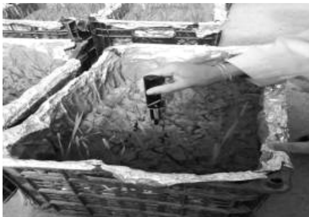
شکل ۱- اندازه‌گیری مقاومت خاک به وسیله فروسنج پس از اعمال بارندگی.
